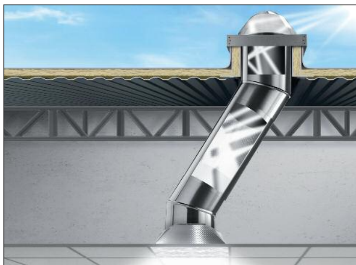
Die spektral selektive Reflexionsbeschichtung sorgt für ca. 99,7 % Lichtspiegelung und reinsten Farbwiedergabe – und das bei sehr geringen UV- und Infrarotstrahlungen. So sind selbst lange Rohrsysteme inklusive 90°-Bögen ohne größere Verluste möglich.
